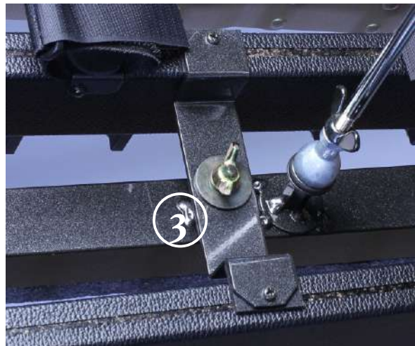
↓ ねじ式ダンパー解放機構 (KV800,700,400)
